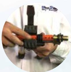
Coloque el accesorio de conexión y el tubo en la herramienta
